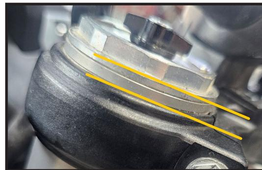
1. Para obtener una sensación de mayor estabilidad y aumentar la altura del tren delantero, el ajuste puede reducirse a 2 mm.
